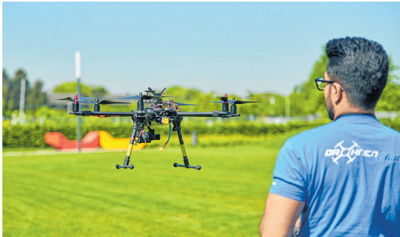
Ali Madershahian von der Drohnengruppe der Hochschule Niederrhein lässt auf dem Campus einen selbstgebauten Hexacopter fliegen.
